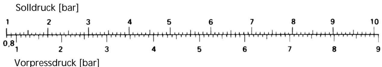
**Achtung:** Der richtige Vorpresdruck kann nur im drucklosen Zustand überprüft bzw. eingestellt werden!
