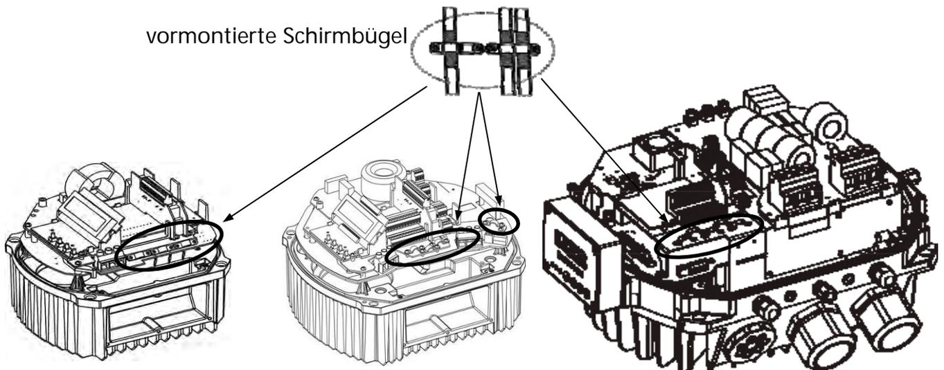
Isolierung der Steuerleitung entfernen und Schirm auf Schirmbügel auflegen.
