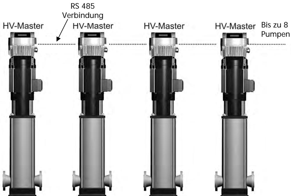
Alle Pumpen können sowohl als Kaskade Seriell wie auch als Kaskade Synchron arbeiten. Jede Pumpe kann als „Führungspumpe“ verwendet werden und wird innerhalb der Gruppe automatisch umgereiht. Bei Ausfall eines „MASTER Inverters“, übernimmt ein anderer die Führungsaktivität und sichert somit die stabile Regelung des Systems. Dies garantiert
