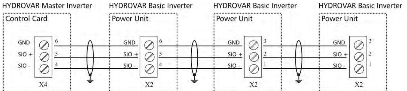
**RS-485 – User Schnittstelle** auf Steuerkarte (für MASTER und SINGLE Inverter): Einer oder mehrere HYDROVAR Geräte können über die standardisierte Modbus Schnittstelle mit externen Geräten (wie z.B. SPS) kommunizieren. Diese Schnittstelle kann für die Parametrierung bzw. zum Auslesen von Daten verwendet werden.
