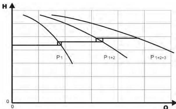
Kalkulation des neuen Sollwertes für Mehrpumpenanwendungen:
