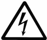
Bei Hochspannungstests des HYDROVAR oder des angeschlossenen Motors kann die Elektronik beschädigt werden!
