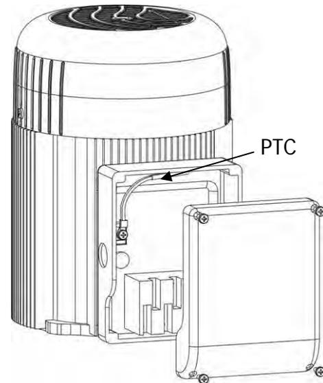
1. Klemmkastendeckel öffnen und Klemmenblock abschrauben
