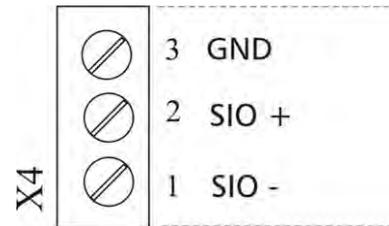
Die **interne RS-485 Schnittstelle** wird zur Kommunikation von mehreren HYDROVAR (bis zu 8) in Verwendung innerhalb einer Mehrpumpenanlage verwendet.
